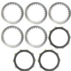
DISCO LAMINA EMBRAGUE Y DISCO PASTA EMBRAGUE P/ FZ16, P/ FZ16S, FZ-16 2.0 (JUEGO)
